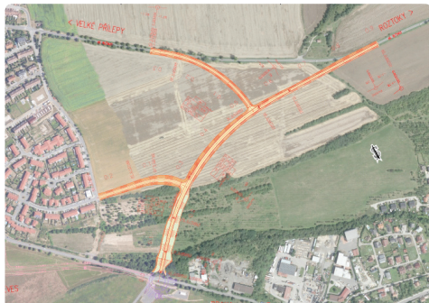
Jižní obchvat – část propojení ulic Pražská a Roztocká
